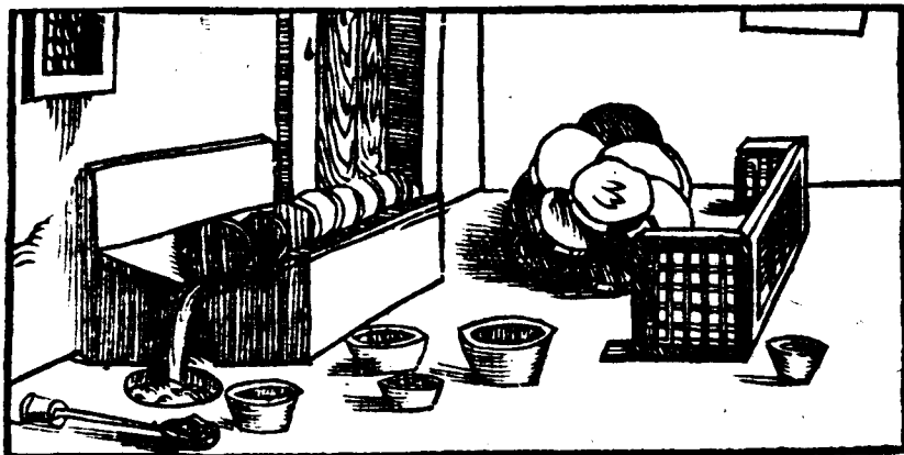
Le moyen d'affiner l'argent avec la coupelle, & de faire les essais de l'argent & de l'or qui sont réduits en masse de metaux. Chap. 6.
